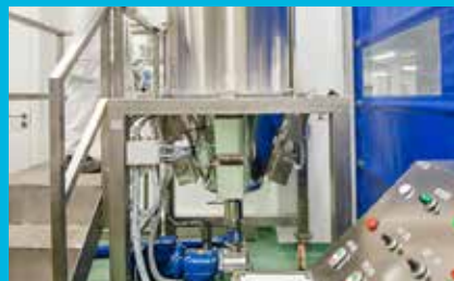
Un nouveau procédé est en cours de développement : l'extraction par ultrasons. Cette innovation technologique va permettre d'obtenir une concentration plus importante en principes actifs (70%) et cela sans solvant.
