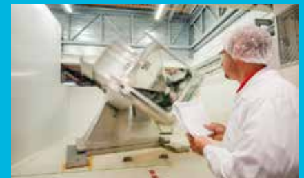
Le Tumbler est une machine qui réalise des mélanges de poudres homogènes par rotations des conteneurs. L'efficacité du mélange est obtenue grâce à la forme du conteneur, son inclinaison sur le Tumbler, la vitesse et la durée de l'opération.
